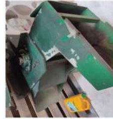
PRESENCIA DE OXIDO
